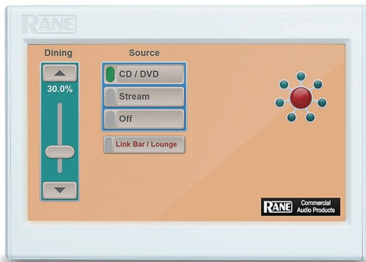
DR6は7インチLCD タッチスクリーン・リモートコントローラーです。Halogenソフトウェアで作成したコントロールページがDR6に表示できます。コントロールページではフルカラーのカスタム背景画像やロゴが使用可能なため、自由度の高いページデザイン・レイアウトが作成できます。またプログラム可能なアンビエント・ライトセンサーが自動的にバックライトの光量をコントロールします。その他、Zonetechマルチゾーン・商業プロセッサーにも対応しており、マスターリモートポートにDR6を接続することで、Zonetechのゾーン全体のコントロールも可能です。
