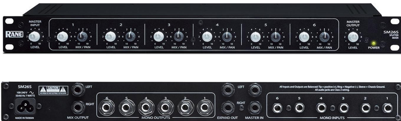
SM26S、様々な用途で使用されることを想定して精巧に設計された汎用性の高い6チャンネルラインレベルスプリッター・ミキサーです。レベルとパン・コントロールが可能な6系統のバランス、アンバランス・ラインレベルの入力に加え、ステレオマスター入力を使用すると、合計で8系統の入力が可能です。ミックスした音声は、全体のマスター出力レベルコントロールに送られ、リアの左右出力に送られます。スプリッターモードでのSM26Sは、1ライン、または2ラインのレベルレベル入力を受け取り、リアの6系統のモノ出力のいずれかにスプリットすることができます。このモードのミックス/パンコントロールは、2系統の入力バスのそれぞれからのレベルを各出力に適用するように調整します。内部ヘッダーブロックにより、ミックス出力が独立したステレオ出力になり、合計で8系統の出力が可能になります。
